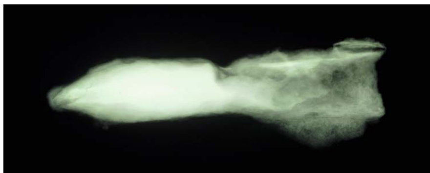
Röntgenfotografi på pilspetsen för att studera djupet på holken samt dess status.
